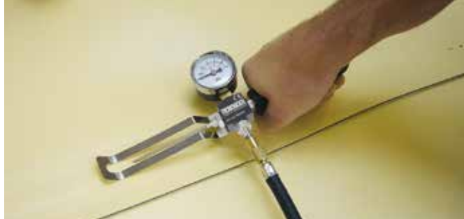
Testování těsnosti svarů s testovacím kanálkem
