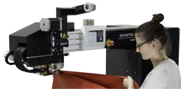
Svařování nízkonapěťovým horkým klínem
